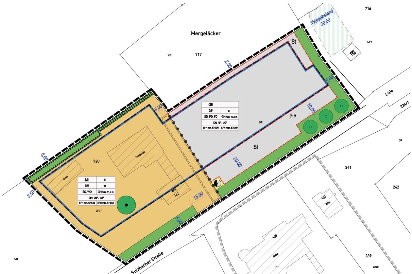
Mit dem vorliegenden Bebauungsplan soll einem im Westen des Plangebiets ansässigen kunststoffverarbeitende Betrieb für Spritzgussteile der Neubau einer Produktionshalle mit Bürotrakt östlich anschließend an die Bestandsbebauung ermöglicht werden. Die bestehenden Räumlichkeiten des Gewerbebetriebs sollen künftig als Lagerräume dienen. Eine spätere potenzielle Erweiterung der geplanten Produktionshalle soll bereits jetzt im Bebauungsplan-Verfahren berücksichtigt werden.
